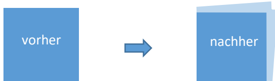
Abbildung 2: schematische Darstellung einer Eloxalschicht bei einer rechteckigen Außenkante
