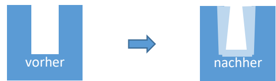
Abbildung 3: schematische Darstellung einer Eloxalschicht bei einer Sacklochbohrung
